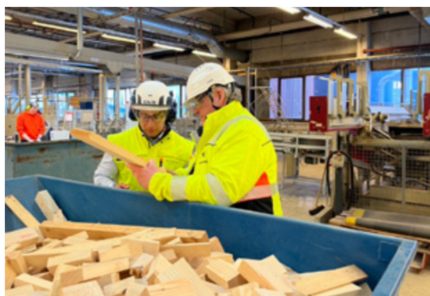
Konsernsjef Morten Kristiansen og systemingeniør Ahmed Nasrullah studerer råstoffbiter som har blitt maskinelt identifisert og kappet ut hos Moelven Profil AS. Utsorteringen skjer på grunn av feil som f.eks kvist, sprekker, kvaelommer etc. Emner med godkjent kvalitet fingerskjøtes og blir til trekomponenter til vindusproduksjon, mens de utsorterte bitene ender som bioenergiråstoff.
